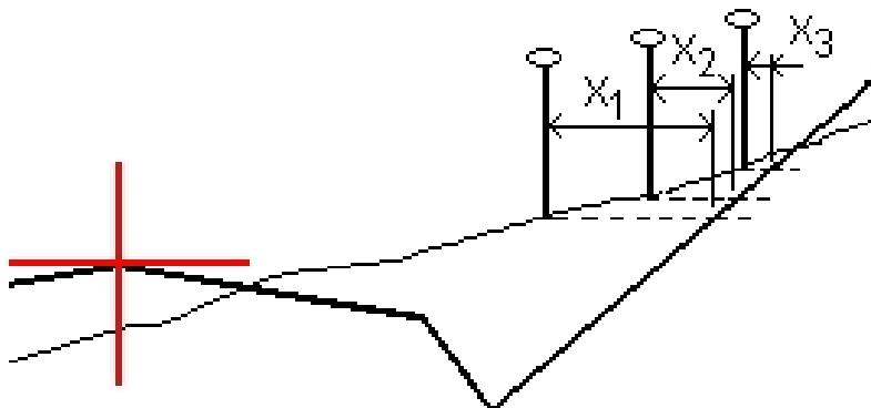
На графическом дисплее в режиме просмотра плана отображается положение пересечения. Вычисленное значение уклона (синее) и значение проектного уклона отображаются в верхней части экрана.
