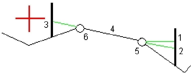
**Примечание** - Для точек с нулевым сдвигом вы не можете использовать Строительный сдвиг в плане со значением уклона предыдущей линии.
